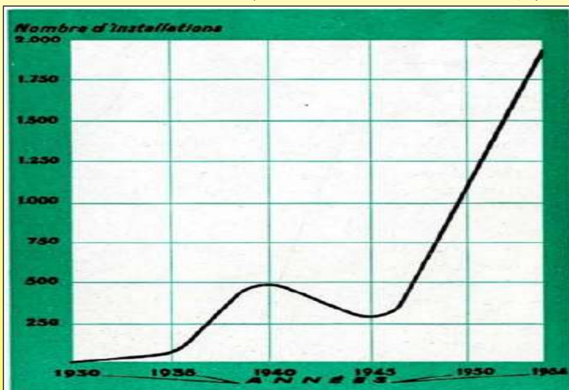
Изменение количества грунтовых тепловых установок, находящихся в эксплуатации с 1930 г.
